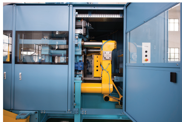
Fot.9. Maszyna serii DISAMATIC C3-350 posiada układ podnoszenia po obydwu stronach płyty uchylnej, wyposażona jest także w płyty grzewcze Fig.9. The 350 series is equipped with lifting tools at both sides of the SP, as well as heating plates
