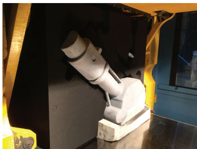
Fot. 6–7. Rdzenie w obydwu połówkach formy; brak ograniczeń dla znaków rdzeniowych
