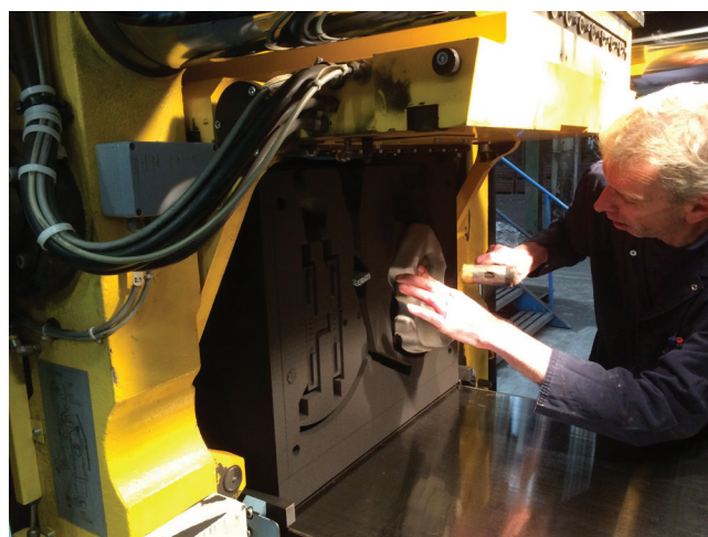
Fot. 2–3. Zastosowanie podpórek oraz dodatkowego mocowania gwoździ w znakach rdzeniowych
