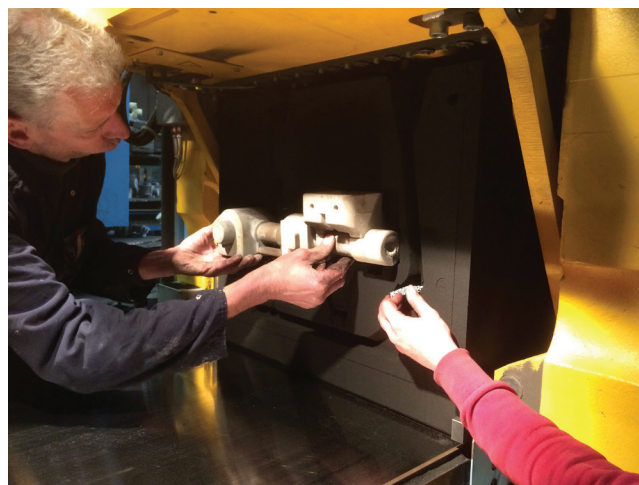
Fot. 4–5. Wystarczający dostęp z obydwu stron do całej powierzchni obydwu połówek formy
