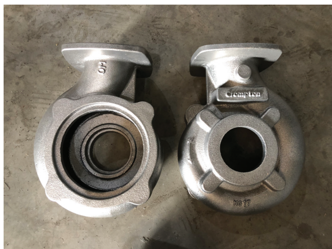
Fot. 10. Odlewy przeniesione na technologię mas wilgotnych bentonitowych Fig.10. Castings converted to the green sand process
