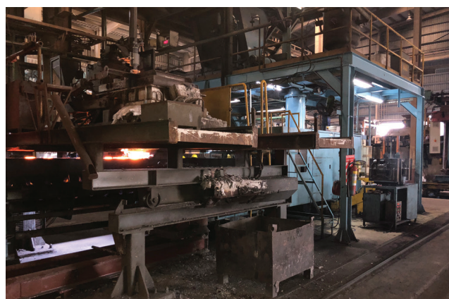
Fot. 12. DISAMATIC i niegrzane urządzenie do zalewania Fig. 12. DISAMATIC and unheated pouring device
