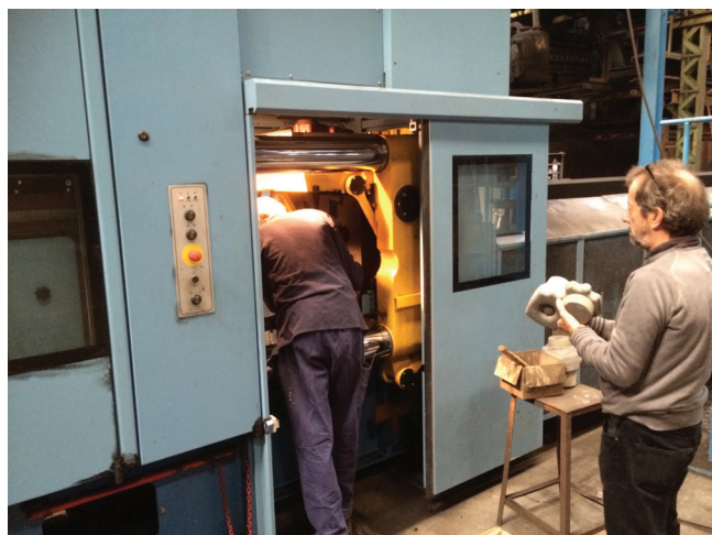
Fot.1. Duże drzwi przesuwne dają swobodny dostęp do formy i umożliwiają włożenie rdzenia
