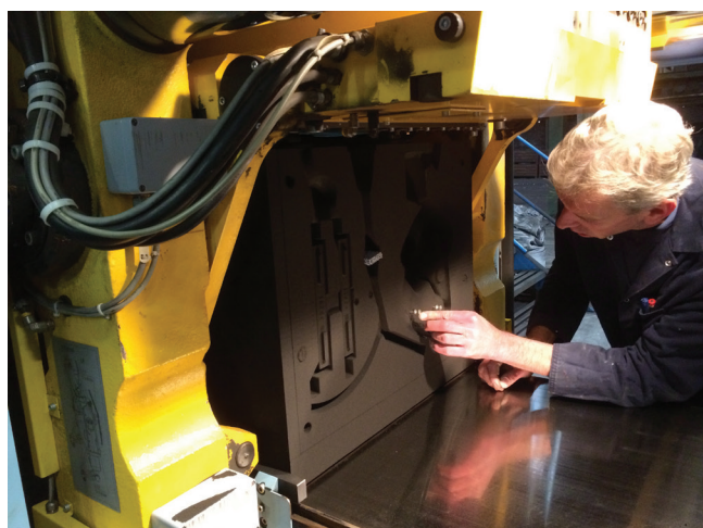
Fot. 2–3. Zastosowanie podpórek oraz dodatkowego mocowania gwoździ w znakach rdzeniowych
